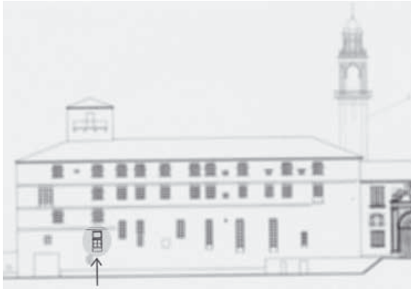
(Fig. 13) Alzado actual da fachada da ala oeste. Na zona nítida da imaxe e sinalada cunha frecha está situada a xanela convertida en porta para comunicar a cociña acondicionada de 1841 coa cociña antiga do convento do século XVII. Fonte: Mosteiros e Conventos de Galicia, Descripción Gráfica dos declarados Monumentos
